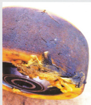
An diesem Polyurethanrad traten Verschleißerscheinungen durch Verflüssigung des Materials auf.
