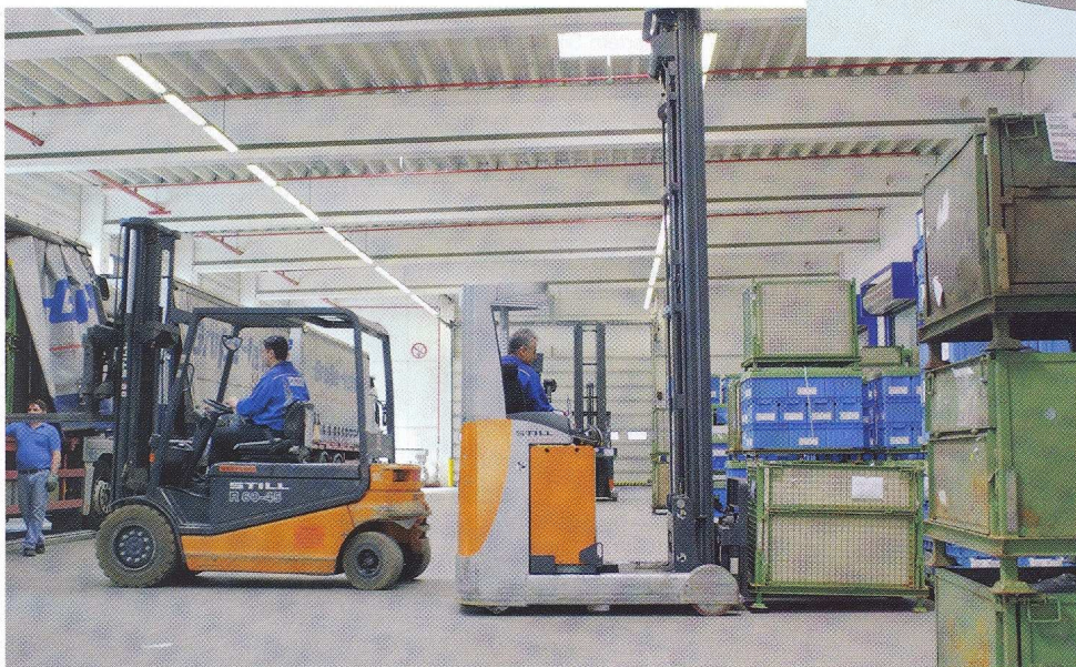
Die Räder von Flurförderzeugen müssen viel aushalten. Reibung, Hitze und Schläge führen zu einem schnellen Verschleiß. Bilder: Still
