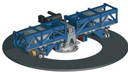
Räder- und Rollenprüfstand für das Projekt „InnoRad“ (Bild: IFT, Universität Stuttgart)
