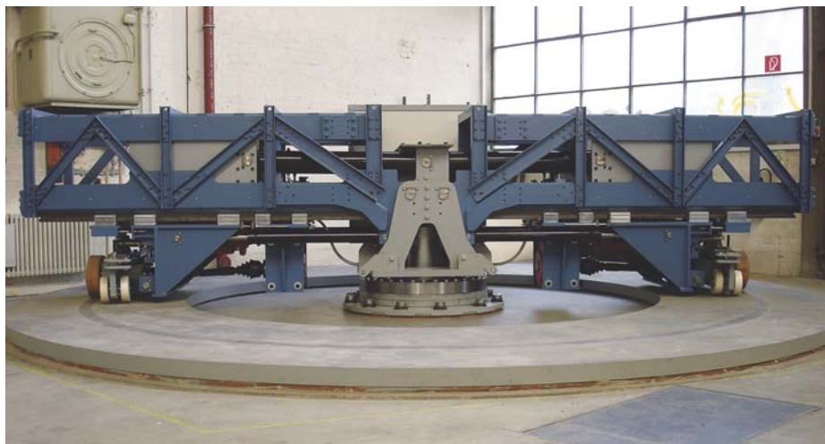
1 Kreisaktuator im Labor des IFT
