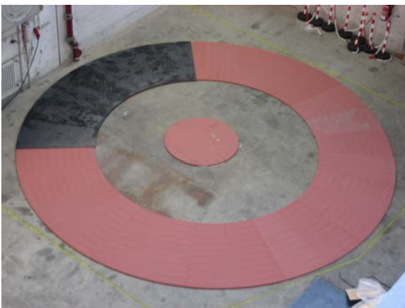
Bild 8.3: Aufbau des Prüfbodens mit Dämmschicht
