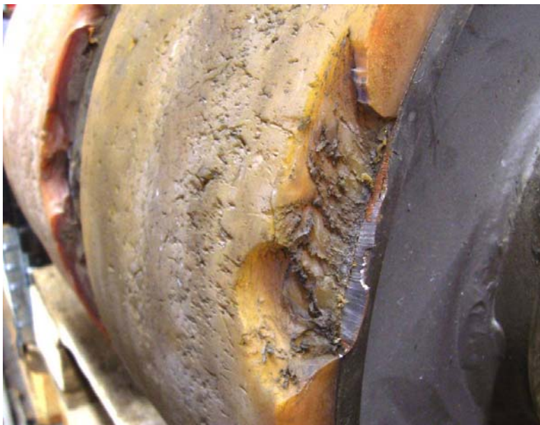
Bild 6.6: Mechanische Beschädigung mit Materialausbruch
