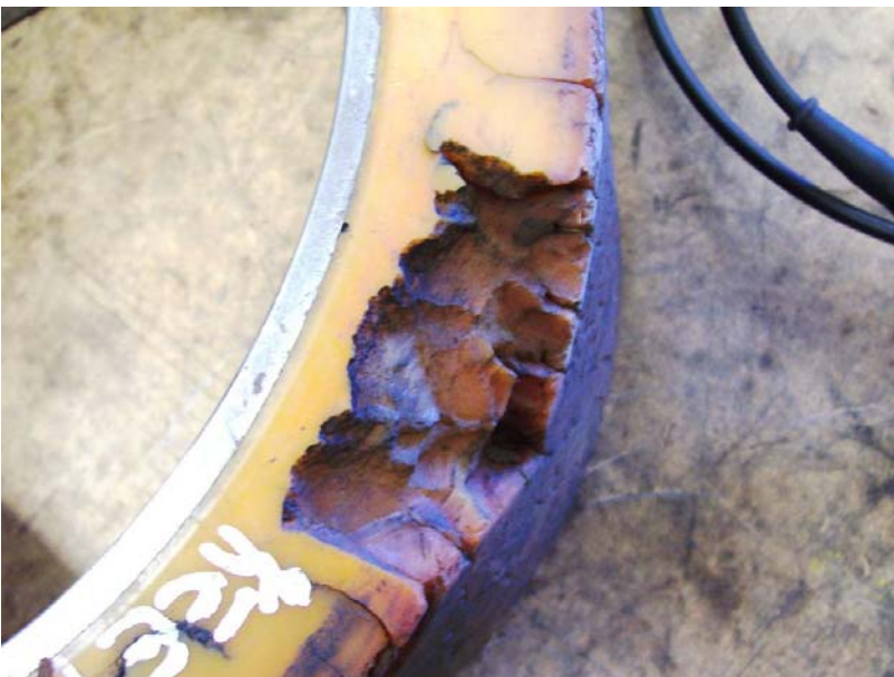
Bild 6.8: Materialausbruch nach mechanischer Beschädigung
