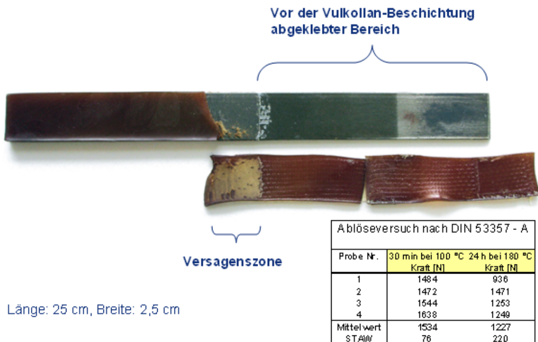
Bild 10.15: Ablöseversuch DIN 53357 Vulkollan® auf Flacheisen ST37
