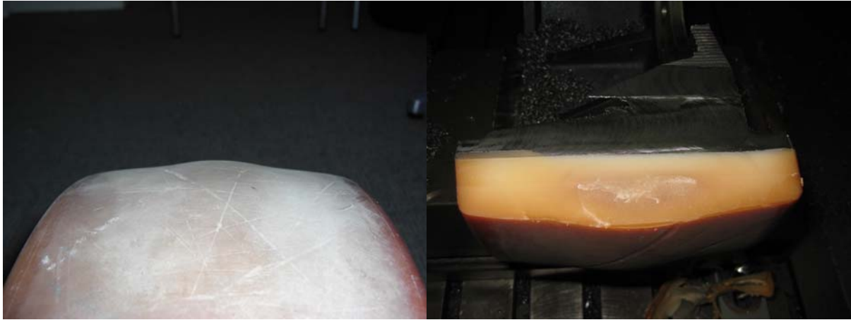
Bild 6.2: Rekristallisiertes Polyurethan im Laufbelag
