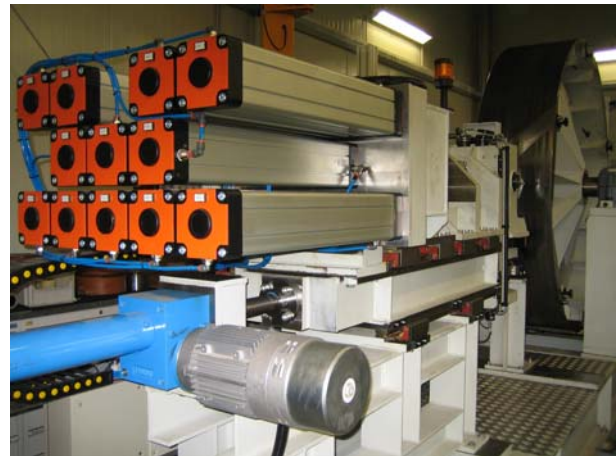
Bild 7.47: Pneumatikzylinder zum Aufbringen der Prüflast
