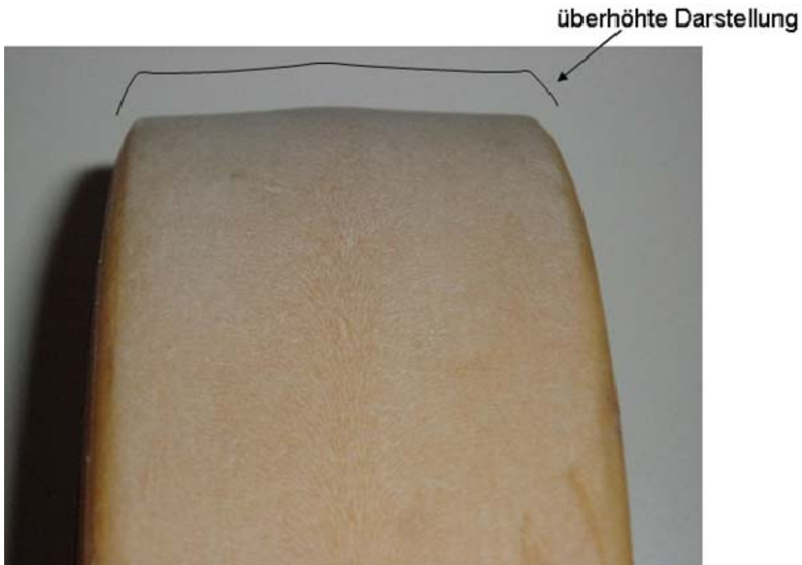
Bild 13.10: Typisches Verschleißbild bei Drehen um die Hochachse („Pagodenverschleiß“ an einer Schwenkrolle)
