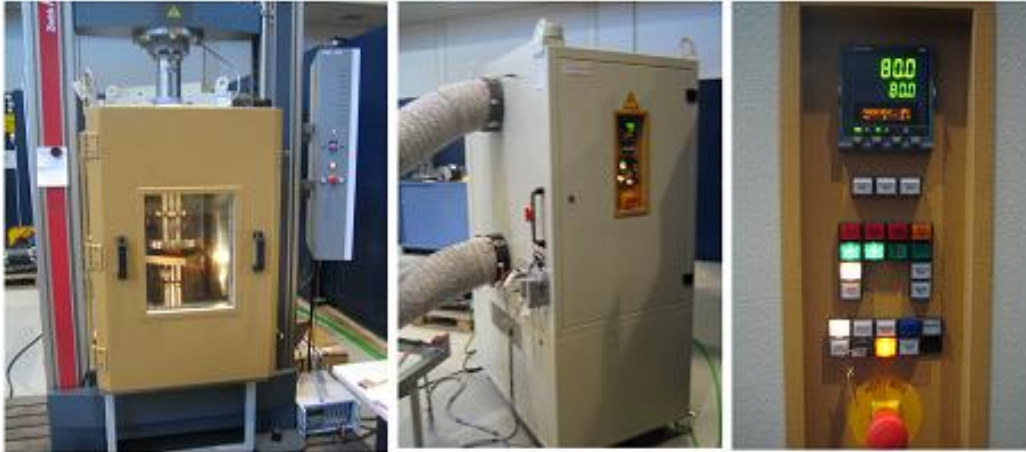
Bild 9.17: Links: Zug-Druckmaschine Zwick Z150 mit Thermokammer, Mitte: Luftkonditioniergerät mit Bedienfeld (rechts)
