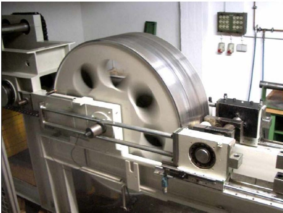
Bild 7.50: Außentrommelprüfstand der Firma Wicke
