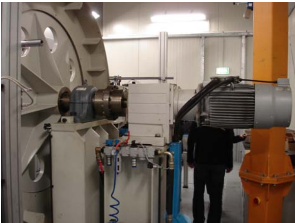
Bild 7.46: Antrieb und Lagerung der Trommel
