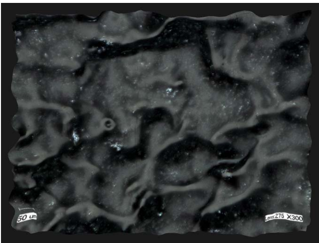
Bild 10.10: Flacheisen ST 37, gestrahlt+ MEK+ Luft+ MEK+ Primer (30' 180°C)
