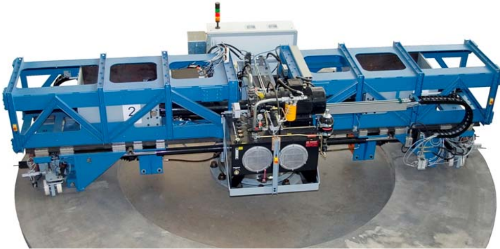
Bild 8.10: Kreisaktuator mit allen mess-, antriebs- und steuerungstechnischen Komponenten
