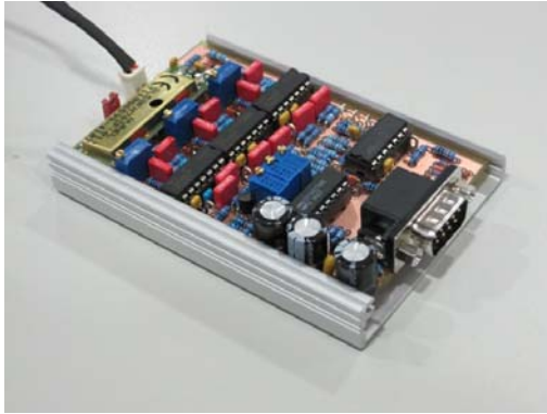
Bild 8.30: 868-MHz-Empfänger mit Frequenz-Shift-Verfahren
