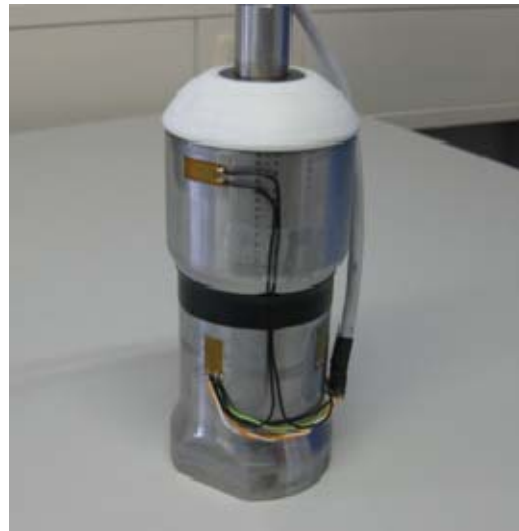
Bild 8.27: Druckstrebe zur Messung der Gewichtskraft
