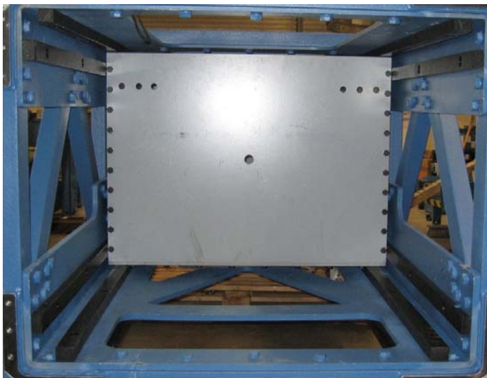
Bild 8.24: Prüflastwanne gelagert auf Kunststoffgleitschienen (schwarz)
