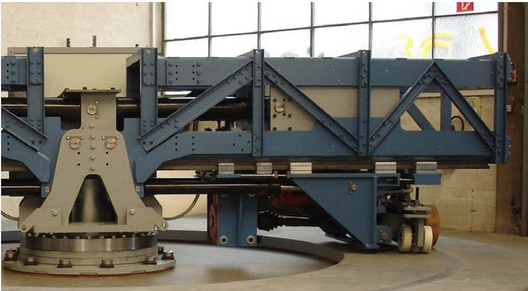
Bild 8.12: Zentrales Drehlager, Zentraler Lagerbock (grau) und Arm
