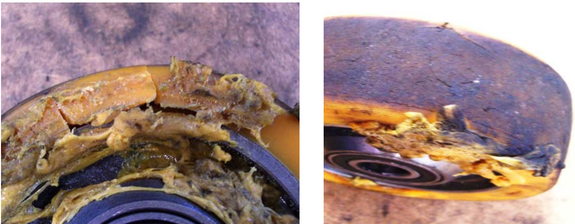
Bild 6.1: Thermisch überlastete Räder mit ausgetretenem Polyurethan
