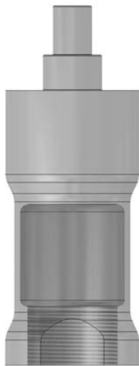
Bild 8.26: CAD-Modell der Druckstrebe (halbtransparent)
