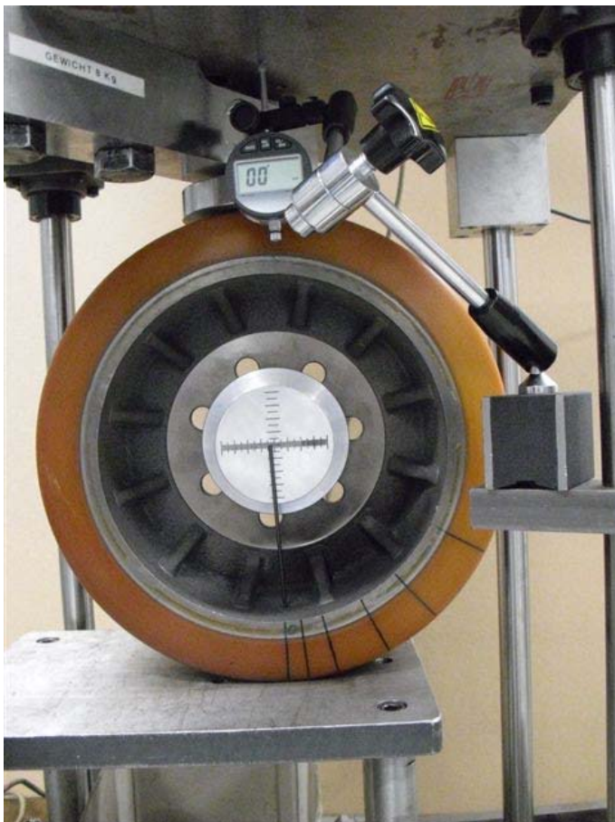
Bild 13.17: Prüfstand zur Durchführung von Testmessungen mit dem Walkometer
