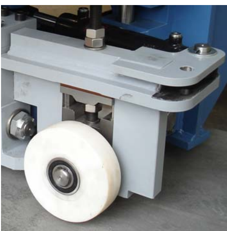
Bild 8.23: Stützrollen zum Abfangen der Radaufhängung im Schadensfall
