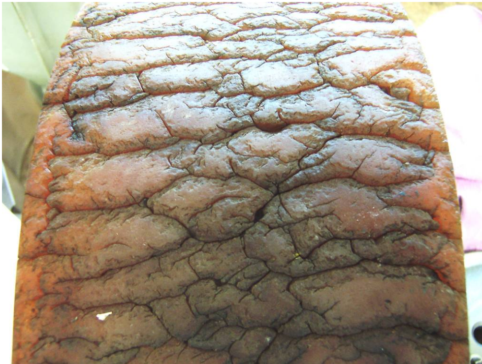
Bild 10.2: Ausfallursache Blumenkohleffekt durch Überlastung erfolgt Rissbildung im Grenzbereich
