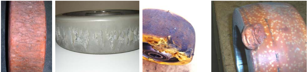
Bild 1.3: Verschleiß- und Ausfallerscheinungen bei Rädern / Rollen von Flurförderzeugen
