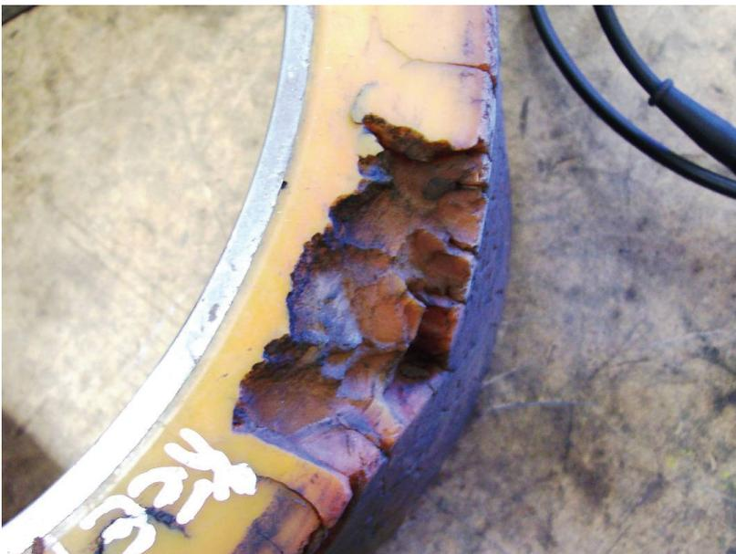
**Bild 6.8:** Materialausbruch nach mechanischer Beschädigung
