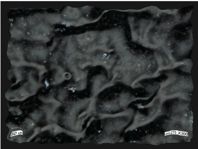
**Bild 10.10:** Flacheisen ST 37, gestrahlt+ MEK+ Luft+ MEK+ Primer (30' 180°C)
