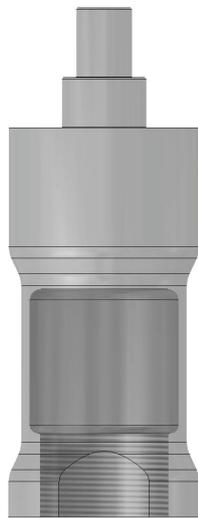
**Bild 8.26:** CAD-Modell der Druckstrebe (halbtransparent)
