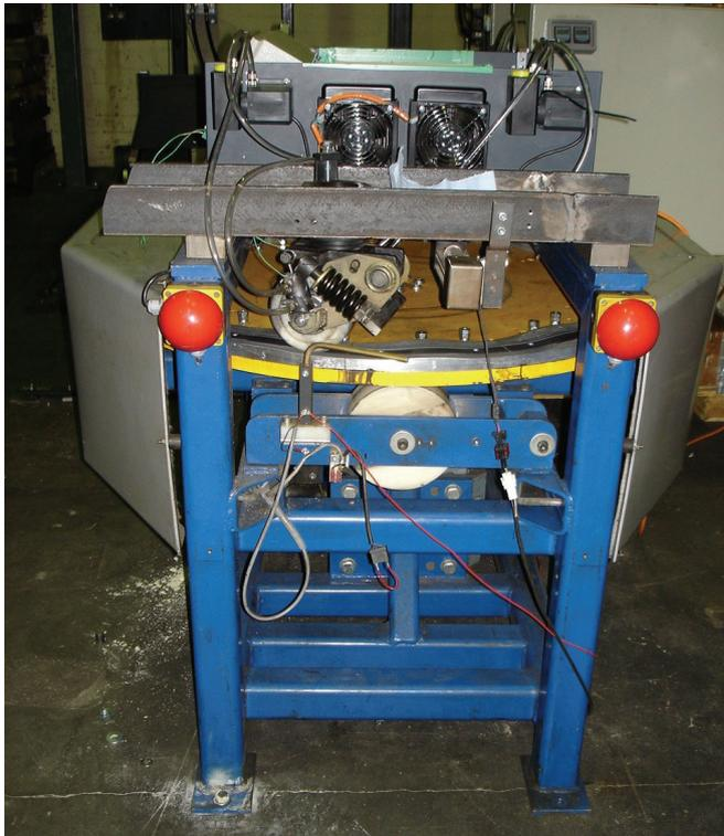
**Bild 7.48:** Sinuswellenprüfstand der Firma Jungheinrich
