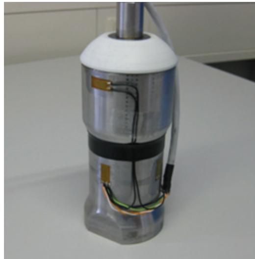
**Bild 8.27:** Druckstrebe zur Messung der Gewichtskraft
