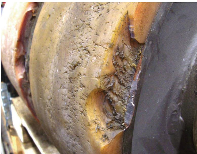
**Bild 6.6:** Mechanische Beschädigung mit Materialausbruch
