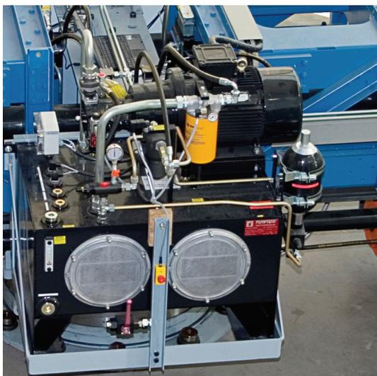
**Bild 8.18:** Am zentralen Lagerbock befestigtes Hydraulikaggregat
