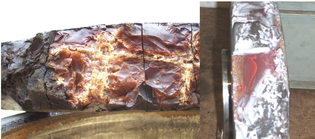
**Bild 6.3:** Hydrolyseschäden
