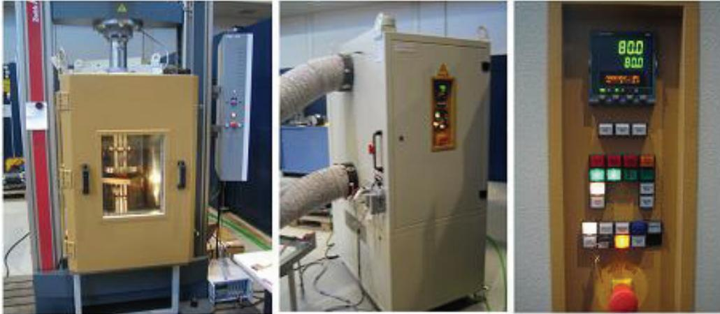
**Bild 9.17:** Links: Zug-Druckmaschine Zwick Z150 mit Thermokammer, Mitte: Luftkonditioniergerät mit Bedienfeld (rechts)
