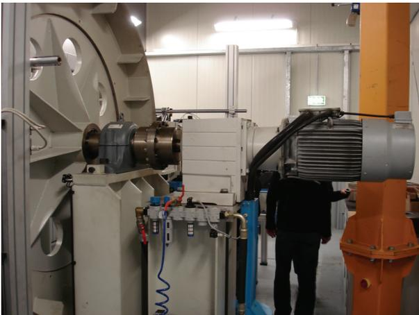
**Bild 7.46:** Antrieb und Lagerung der Trommel
