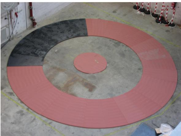
**Bild 8.3:** Aufbau des Prüfbodens mit Dämmschicht
