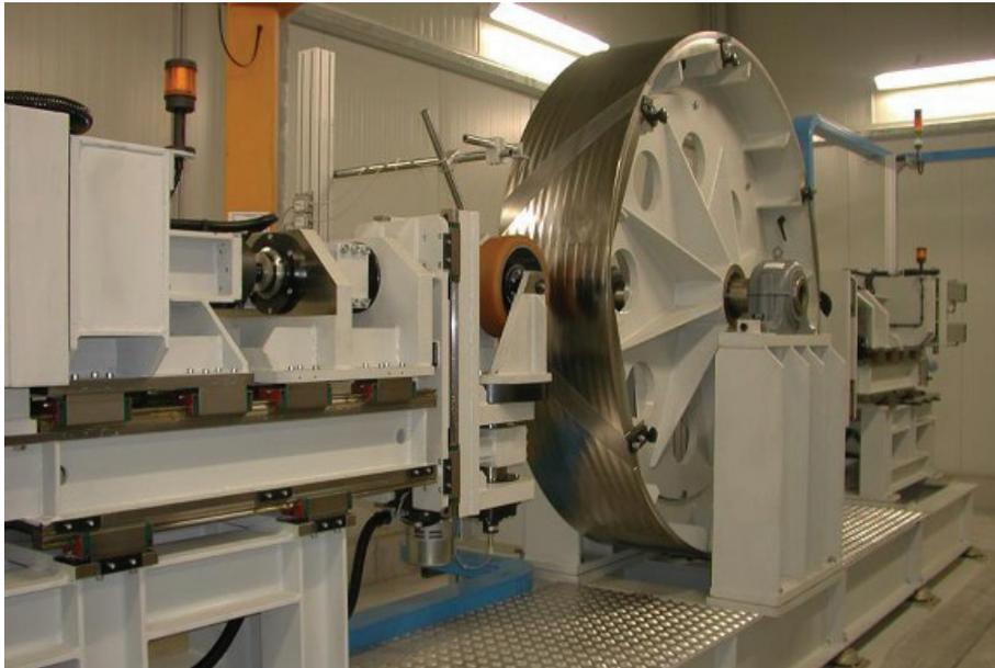
**Bild 7.45:** Außentrommelprüfstand der Firma Räder-Vogel
