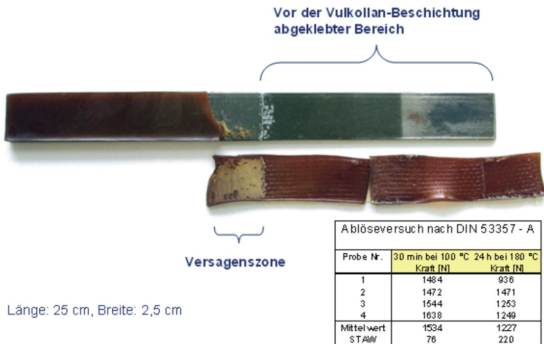
**Bild 10.15:** Ablöseversuch DIN 53357 Vulkollan® auf Flacheisen ST37
