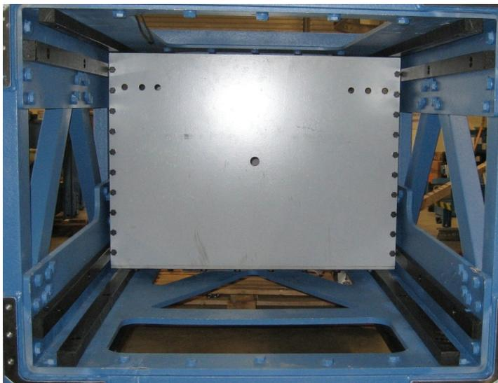
**Bild 8.24:** Prüflastwanne gelagert auf Kunststoffgleitschienen (schwarz)
