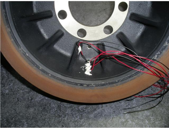
**Bild 8.34:** Temperaturmessung im Rad
