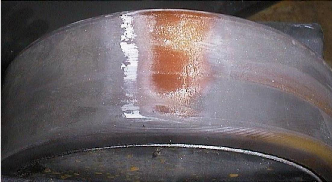
**Bild 6.7:** Abplattung („Bremsplatten“)
