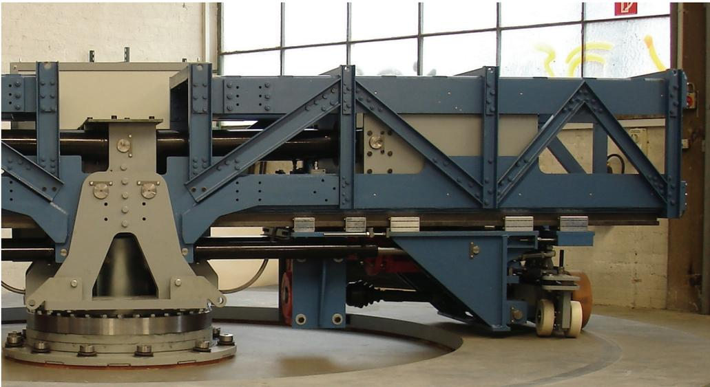
**Bild 8.12:** Zentrales Drehlager, Zentraler Lagerbock (grau) und Arm
