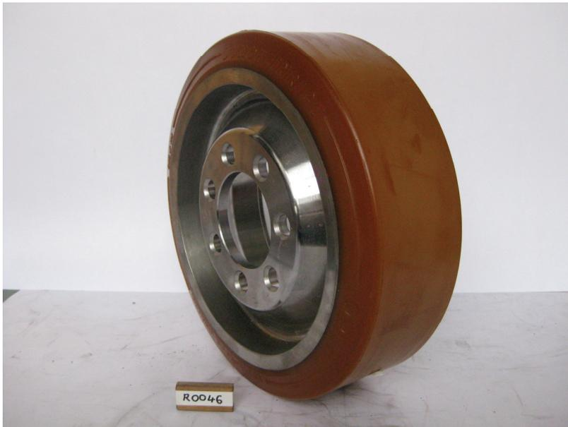
**Bild 14.11:** Rad mit veränderter Felgenreometrie
