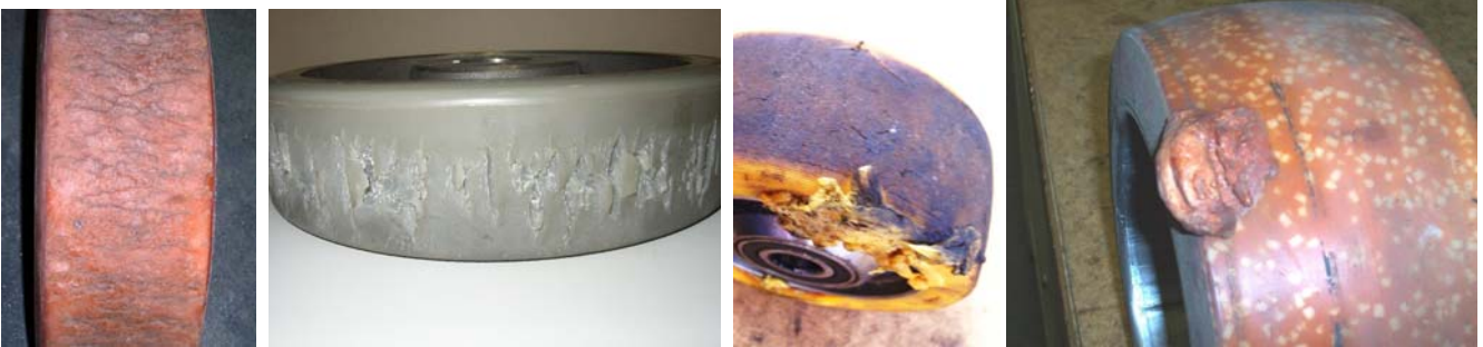
Abbildung 3: Verschleiß- und Ausfallerscheinungen bei Rädern / Rollen von Flurförderzeugen
